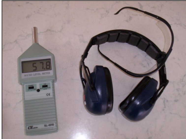
Şekil 1. Gürültü seviyesi ölçüm cihazı.
