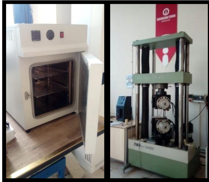
Şekil 1: Kurutma fırını ve 50 ton kapasiteli presleme tezgâhı
