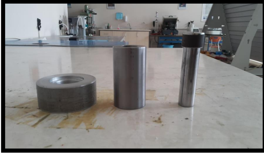
Şekil 3: Silindirik numune üretim kalıbı
