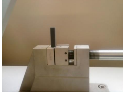
Şekil 5. Deney numunesinin çentik (izod) darbe test cihazına bağlanması
