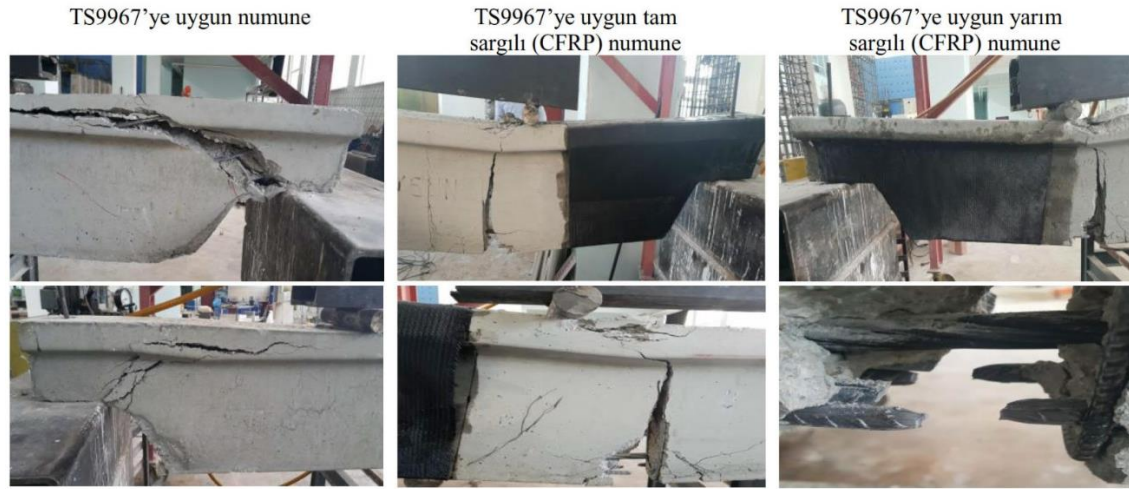
Şekil 6. İnceltilmiş uç bölgelerinde oluşan hasarlar
