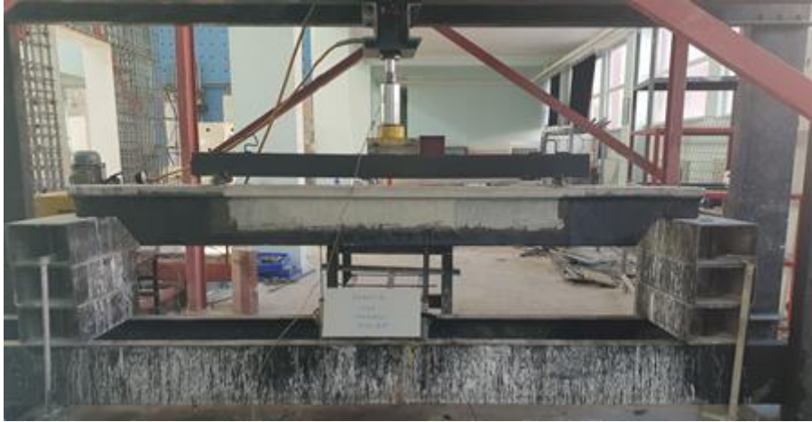
a) TS9967'ye uygun çekme bölgesi sargılı ve iki ucu tam sargılı numune
