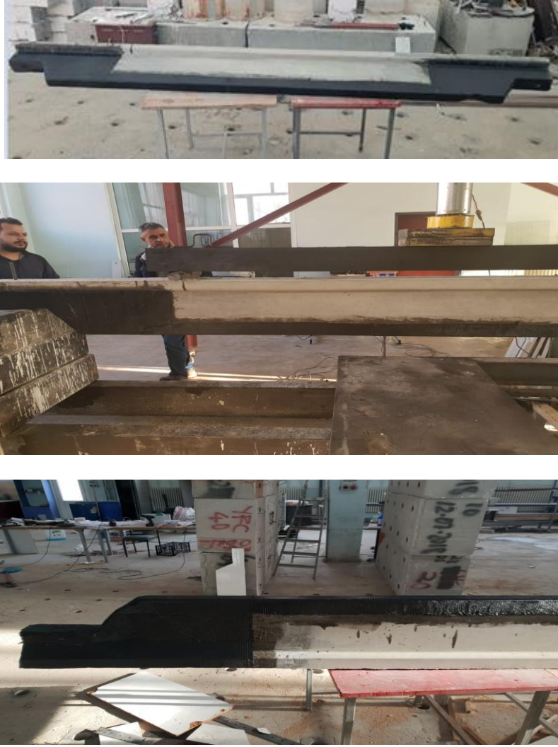
Şekil 2. Tam ve yarım sargılı numuneler
