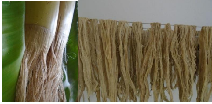
Şekil 3. Muz Lifi Çıkarma Makinesinden Elde Edilip Kurumaya Bırakılmış Lifler
