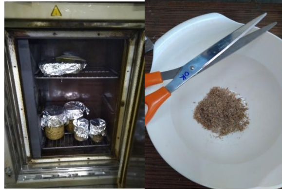
Şekil 4. Liflerin Fırınlanması ve Uygun Boyutlarda Kesilmesi
